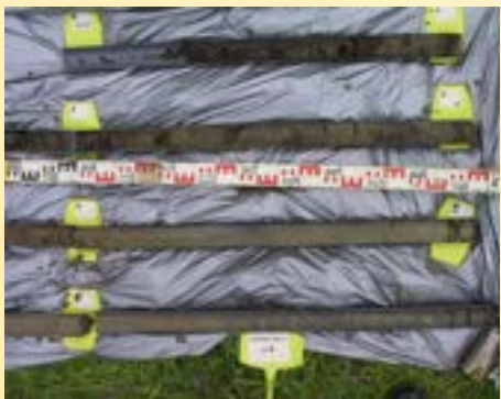
Figuur 6. De met de Aqualock verkregen bodemonsters
